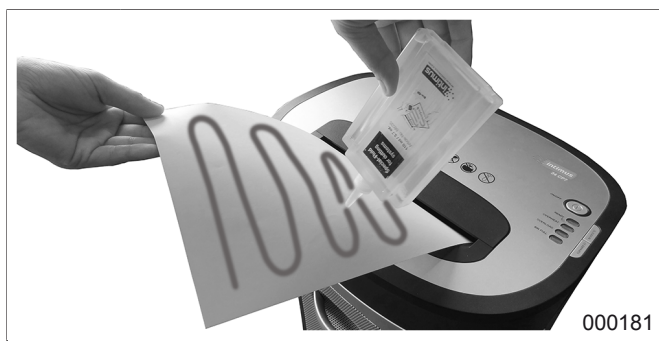
fig.2 Lubrifier le bloc de coupe
