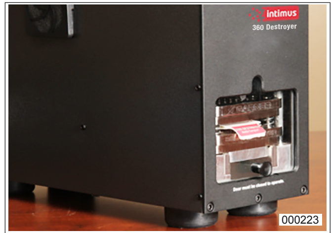
Abb. 12 Zerstörung eines SSD-Laufwerks
