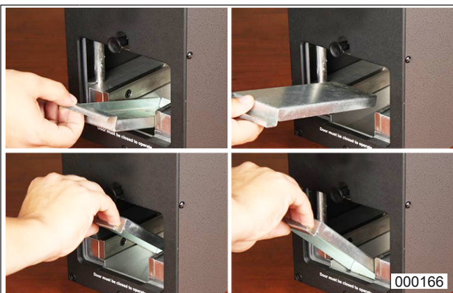
Abb. 13 Tipp: Reinigung mit Hilfe des Auffangbehälters
