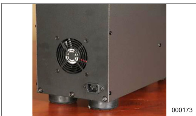
Fig. 17 Exhaust Exit Fan
