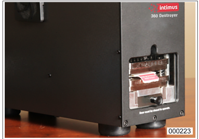
fig. 12 Destrucción de unidades SSD
