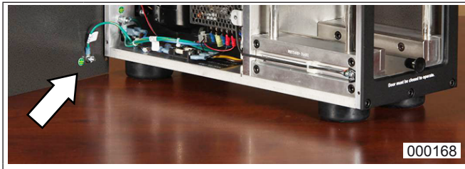
fig. 2 Panel lateral con el cable de tierra abierto
