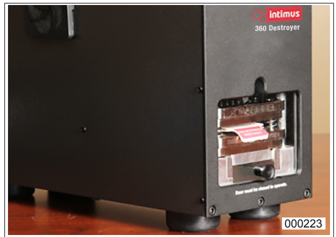
fig.12 Destruction d'un disque dur SSD
