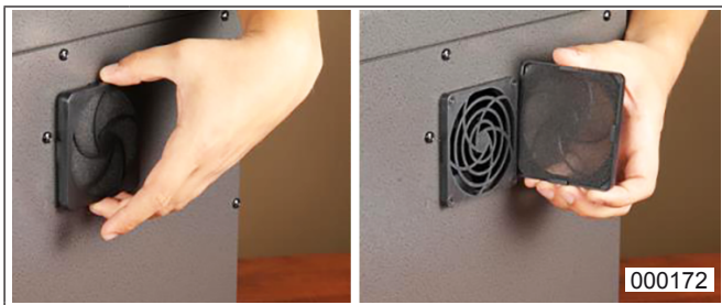
fig. 16 Filtro de aire
