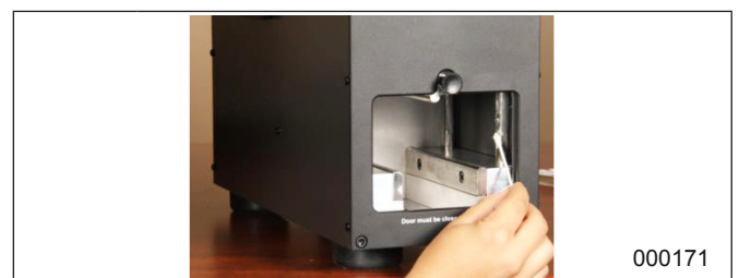
Abb. 15 Senkrechte Seitenschienen einfetten
