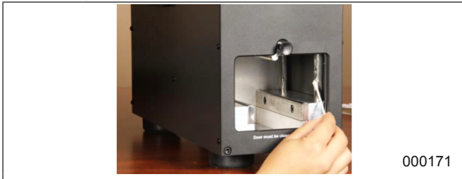
fig. 15 Lubrifier les rails coulissants du Vertical Crusher
