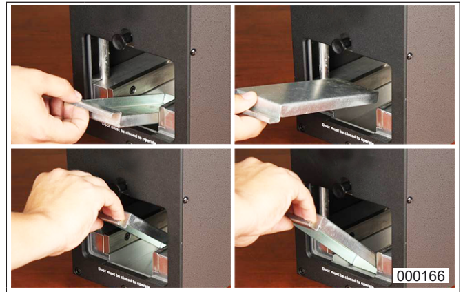
fig.13 Astuce : utiliser le bac pour débris pour le nettoyage
