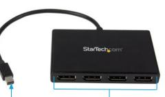
Integrated mini DisplayPort DisplayPort output ports input cable
