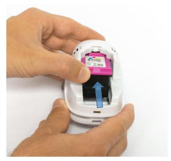
Fig. 47: Insert ink cartridge
