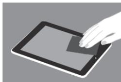
3. Coloque ahora la lámina en la posición de montaje correcta. Observe la correcta dirección - ¡el lado al que se le ha sacado la lámina portadora debe mirar hacia abajo! Se recomienda la colocación sobre el lado largo de la pantalla. En caso necesario, corrija levemente la posición de la lámina. Ajuste ahora la lámina al marco de la pantalla.
