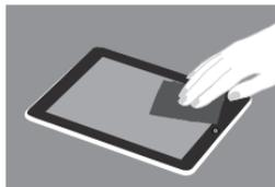
3. Posizionare la pellicola nella posizione corretta per il montaggio. Prestare attenzione alla direzione corretta! Il lato senza pellicola deve essere disposto verso il basso! Si consiglia l'applicazione sul lato longitudinale del display. Se necessario, correggere leggermente la posizione della pellicola. Adattare quindi la pellicola alla cornice del display.
