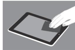
3. Bringen Sie nun die Folie in die korrekte Position zur Montage. Beachten Sie die richtige Richtung - die gerade von der Trägerfolie befreite Seite zeigt nach unten! Empfohlen wird das Anlegen auf der Längsseite des Displays. Korrigieren Sie die Lage der Folie geringfügig, falls erforderlich. Passen Sie nun die Folie in den Rahmen des Displays ein.
