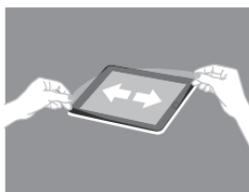
4. Ejercer una leve presión sobre la pantalla para que la lámina quede por completo encima de la pantalla. Para ello, empiece por el lado largo.
